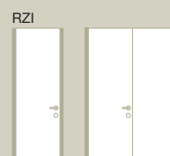
Raumhohe Zarge ohne Querteil, ohne Kämpfer bis Raumlichte von 2600 mm (einflügelig, zweiflügelig)
